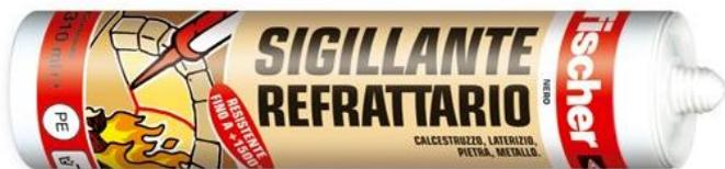
**Sigillante Refrattario** è una pasta sigillante monocomponente, pronta per l'uso, di alta qualità a base di silicato di sodio, resistente alle temperature elevate e al contatto con la fiamma libera fino a +1500°C. Dopo l'indurimento, che avviene per essiccamento, il prodotto assume una consistenza rigida, non si sbriciola, non si spezza, non si deforma e non si fessura.
