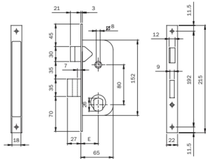
Serratura per cancello. Scatola e frontale zincati tropicalizzato. Funzionante con cilindro  $\varnothing$  mm 26 sfaccettato.
