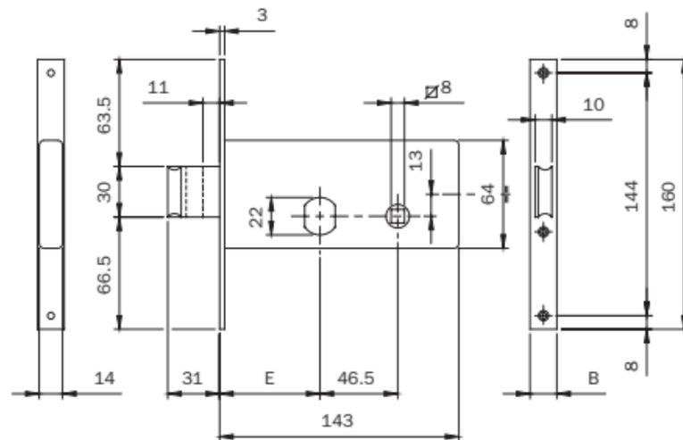
Serratura per fascia. CHIUSURA LATERALE. Funzionante con **CILINDRO TONDO SFACCETTATO Ø MM 22** (840027277) in dotazione. 3 CHIAVI. Scatola H 64 ZINCATA. Frontale mm **160x16x3** zincato.
