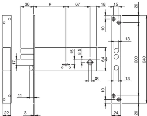
Serratura da infilare doppia mappa per fascia. CHIUSURA LATERALE. 3 CHIAVI da **mm 79**.
