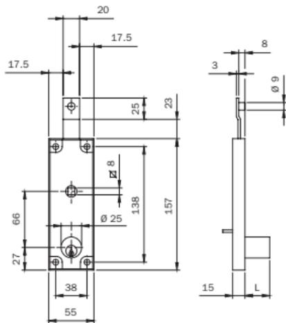
Serratura per serranda. Applicazione **VERTICALE**. Scatola verniciata. CATENACCIO zincato con PERNO  $\emptyset$  mm 9X8 PER AGGANCIAMENTO ASTA. 1 mandata da mm 25 con maniglia, QUADRO MANIGLIA mm 8, sbloccaggio maniglia con cilindro tondo  $\emptyset$  mm 25 dall' esterno e con levetta dall'interno. Cilindro sporgente dalla scatola serratura. 2 CHIAVI A PROFILO STANDARD (chiave grezza codice 020259).
