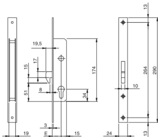
Serratura da infilare per montanti, CHIUSURA LATERALE, cilindro a profilo europeo.
