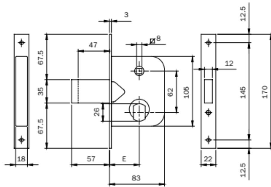
Serratura per cancello. Scatola e frontale zincati tropicalizzato. Funzionante con cilindro D mm. 26 sfaccettato.
