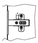
Un completo sistema di basi metalliche permette un rapido montaggio ed una regolazione di  $\pm~2$  mm
