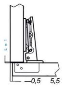
Una nuova tecnica di regolazione laterale permette uno spostamento della porta di -0,5/+5,5 mm mantenendo inalterato il valore "L" di 1 mm senza intervenire sulla vite di fissaggio
