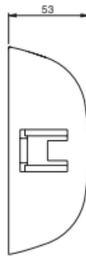
Coppia scrocchi per antipanico **“IDEA Base”**. Chiusura laterale superiore e inferiore. Scrocco in zama senza autobloccante. Solo per porte antipanico. Due incontri 94100100. Viti di fissaggio.
