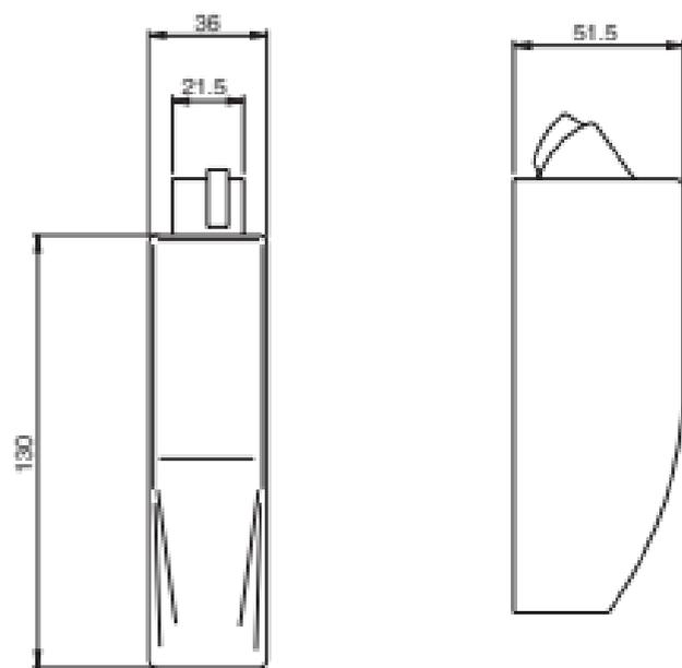
**Coppia scrocchi** per antipanico **“Push Bar”**. Chiusura verticale alto e basso. Scrocco in acciaio con autobloccante, idoneo per porte TAGLIAFUOCO. Incontri 94100110+94100120. Viti di fissaggio.
