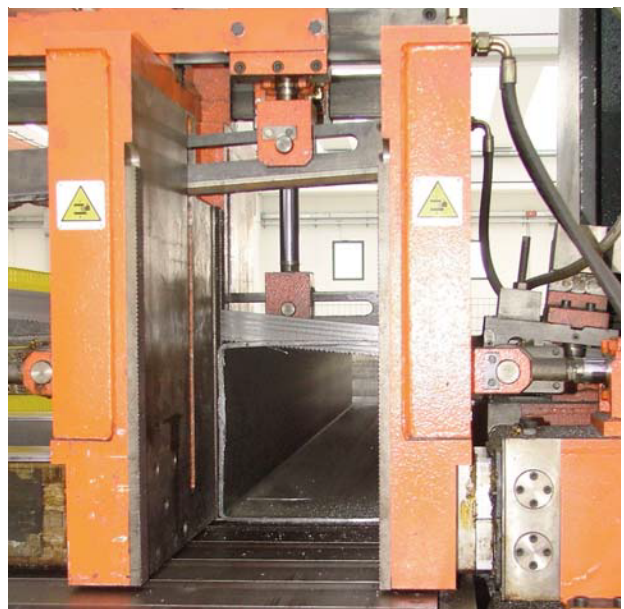
A sinistra e sotto le varie fasi di taglio su un tubolare.
