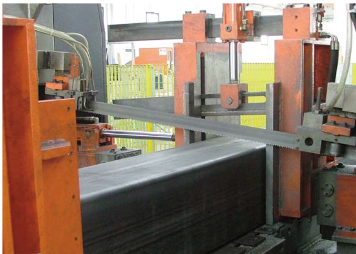
Qui sopra la segatrice Friggi, che permette il taglio di travi e tubolari.
