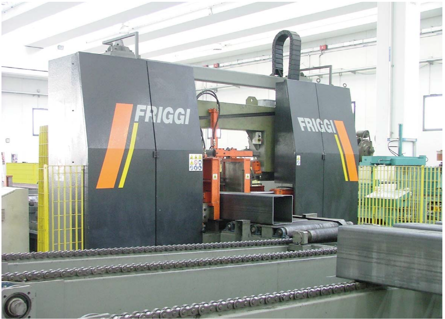
Qui sopra la segatrice Friggi, che permette il taglio di travi e tubolari.
