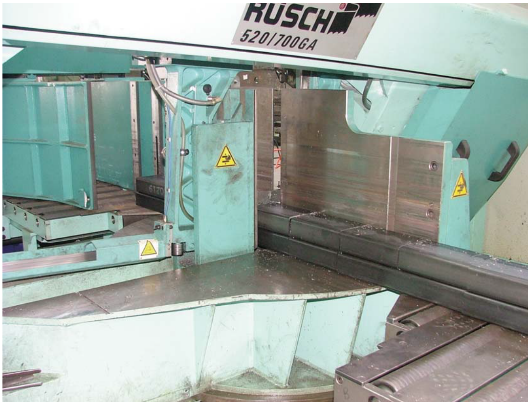
A lato la segatrice con taglio a gradi, durante un'operazione di taglio. Può effettuare tagli inclinati su travi e tubolari.
